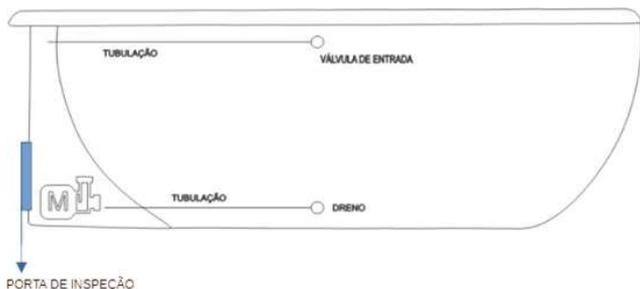
As tubulações da válvula de entrada e drenagem, serão direcionadas de fábrica, para onde fica o motor e a tampa de inspeção.
